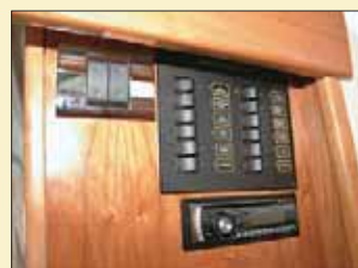
Un costado de la escalera presenta el panel eléctrico de la embarcación, con visualización directa y clara de todos los servicios de a bordo.
