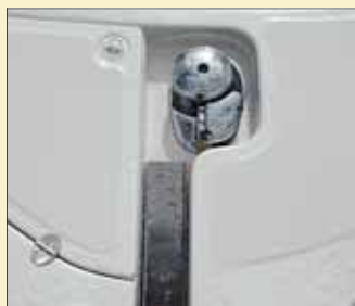
La maniobra de fondeo cuenta con pozo de anclas, con apertura en estribor, y molinete, por detrás de la roldana y hundido en un hueco específicamente diseñado.
