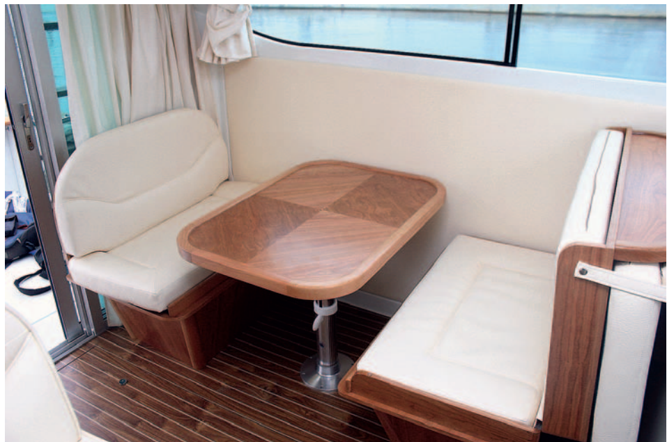
El salón puede convertirse en una litera doble gracias al pie telescópico de la mesa. Bajo los bancos hay más tambuchos de estiba.
