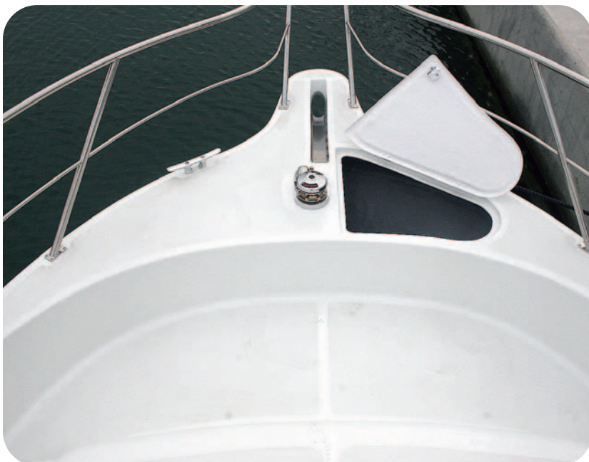
El cofre de fondeo es profundo y el púlpito de proa abierto.
