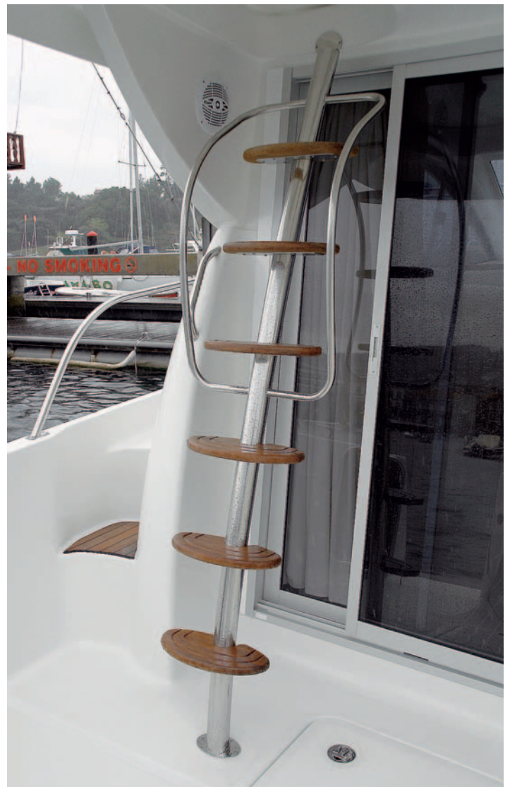
La original escalera incluye unos pasamanos en la parte alta.
