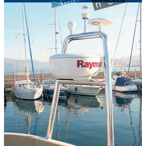
Una simple torreta tubular para las antenas
