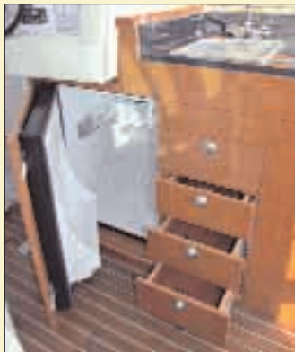
La parte baja de la cocina instala un armario bajo y cajones, desplazándose la nevera hacia proa, bajo el asiento del timonel.
