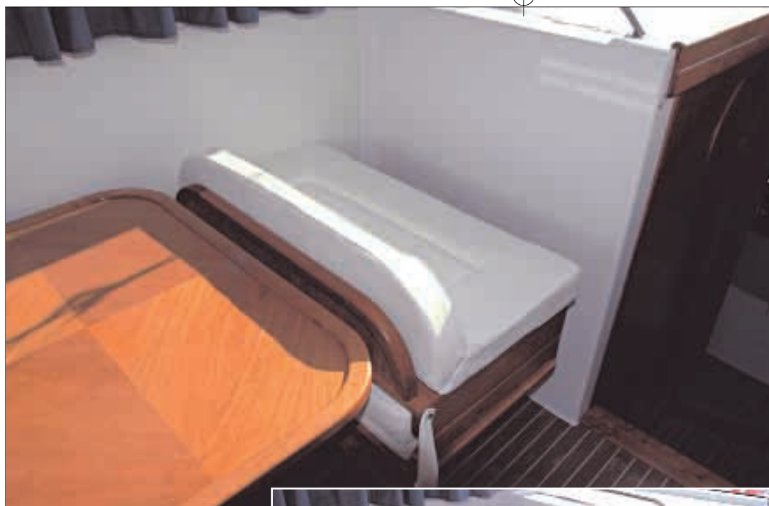
Un mecanismo basculante permite ▲ transformar el asiento más adelantado de la dinette en un puesto de copiloto de gran anchura. ►
