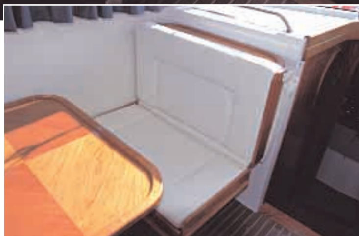
Un mecanismo basculante permite ▲ transformar el asiento más adelantado de la dinette en un puesto de copiloto de gran anchura. ►
