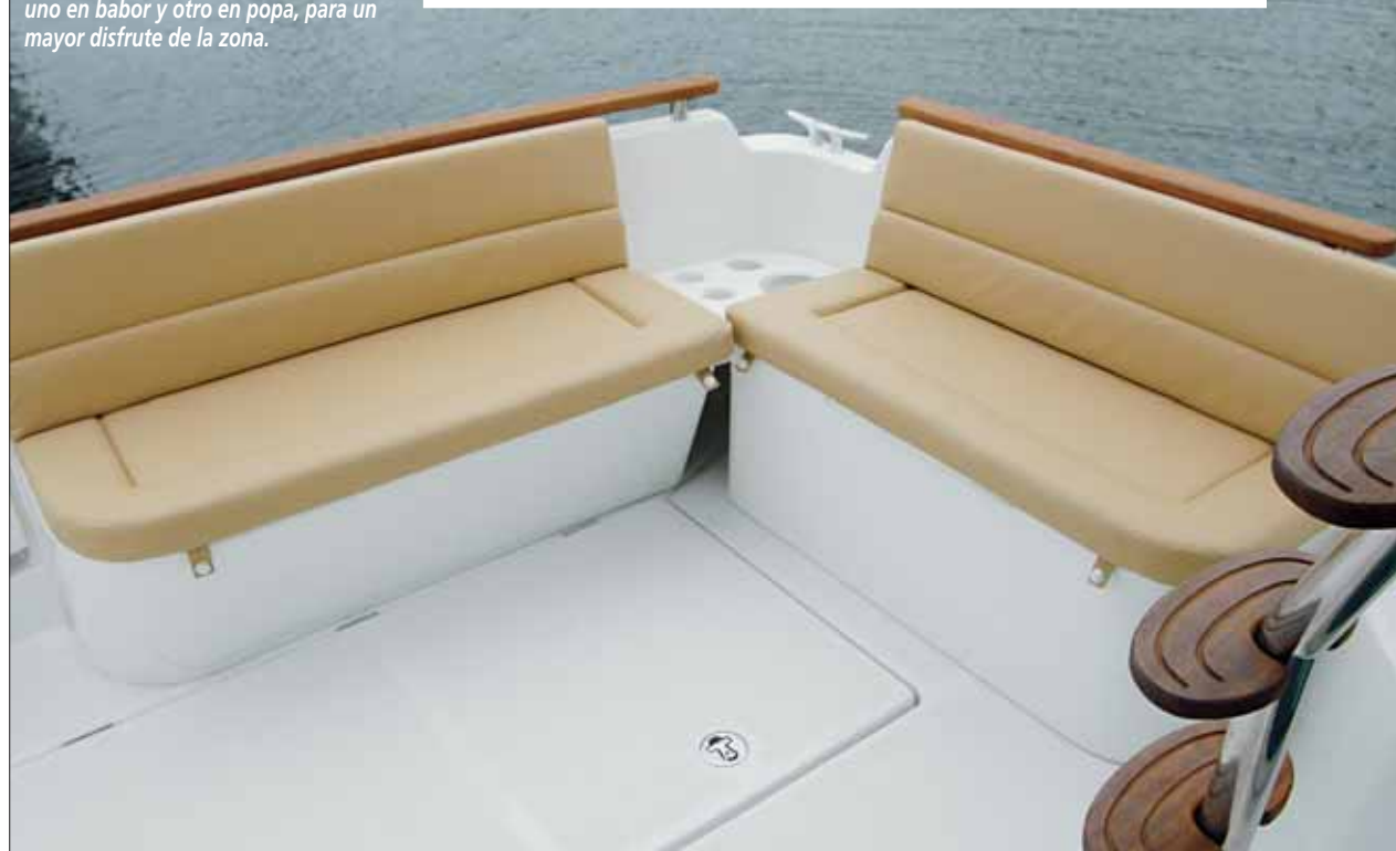
Una portezuela de PRFV instalada en el espejo de popa garantiza una circulación segura entre la plataforma de baño y la bañera.
