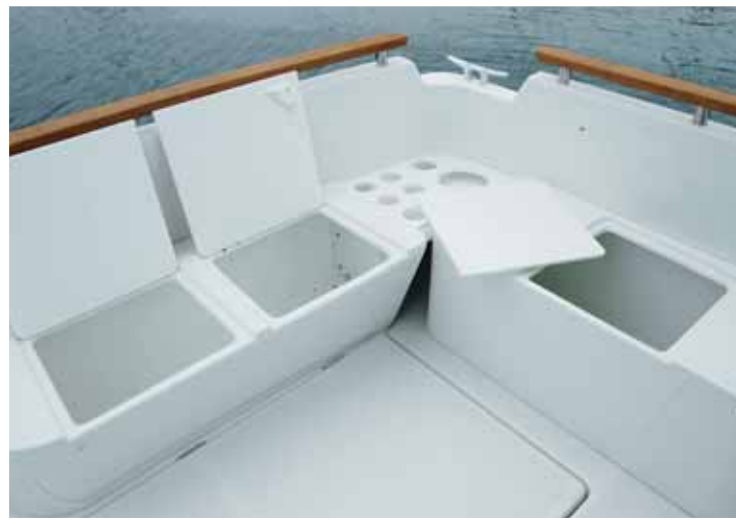
Los bancos situados en la bañera ocultan tres cofres para el almacenamiento de todo tipo de elementos. ▼
