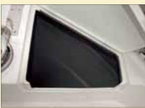
El extremo de proa incluye un profundo cofre de anclas junto al que se instala el molinete eléctrico de serie.
