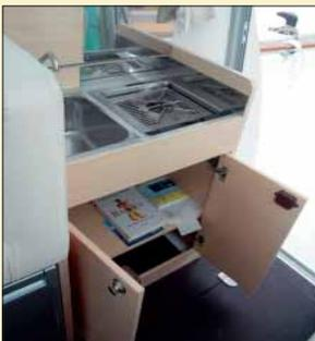
La cocina queda ubicada en estribor, junto a la entrada, y ofrece un quemador de alcohol, un fregadero de acero inoxidable y un armario de almacenamiento doble de forma estándar.
