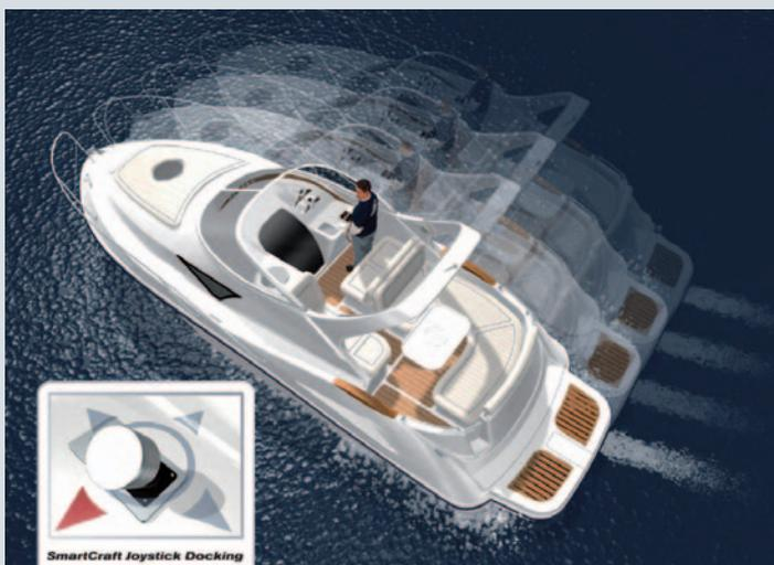
El sistema Axius permite, además de otras funciones, el desplazamiento de la embarcación en cualquier sentido.
