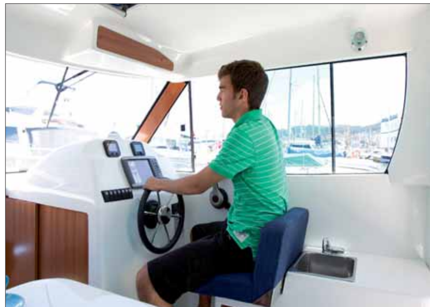
▲ El puesto de gobierno ocupa la sección frontal de estribor de la timonera, donde dispone un sillón individual de pilotaje y una consola de mando de PRFV.
