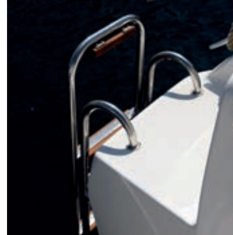
La escalera de estiba exterior.
