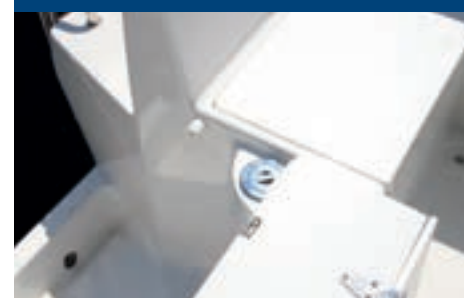
La toma de combustible en popa.
